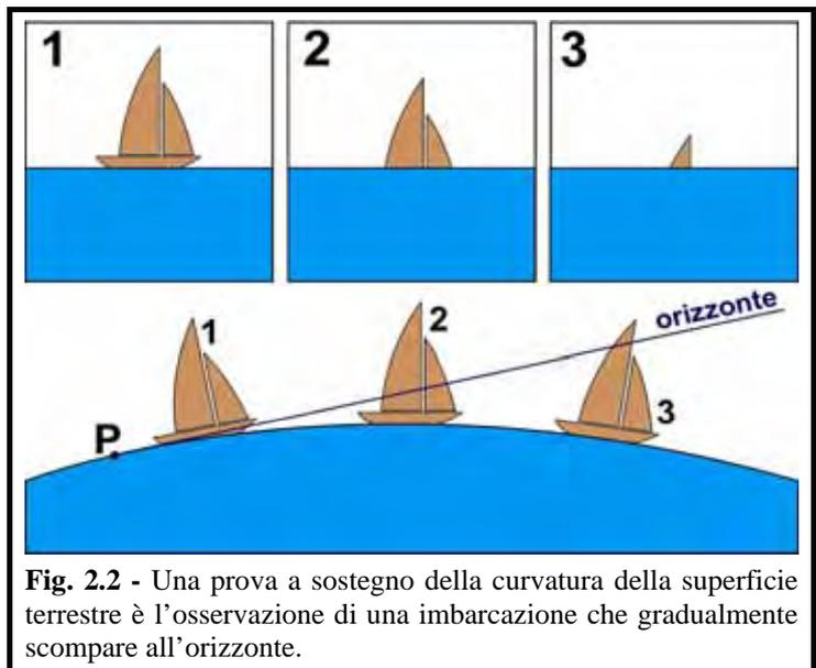
**Fig. 2.2** - Una prova a sostegno della curvatura della superficie terrestre è l’osservazione di una imbarcazione che gradualmente scompare all’orizzonte.
