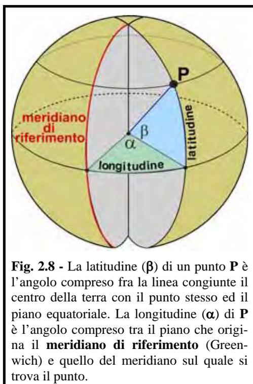
**Fig. 2.8** - La latitudine ( $\beta$ ) di un punto **P** è l'angolo compreso fra la linea congiunte il centro della terra con il punto stesso ed il piano equatoriale. La longitudine ( $\alpha$ ) di **P** è l'angolo compreso tra il piano che origina il **meridiano di riferimento** (Greenwich) e quello del meridiano sul quale si trova il punto.
