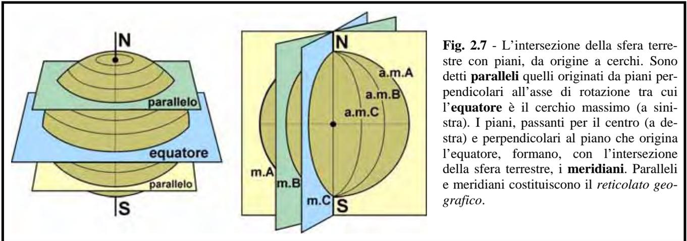
**Fig. 2.7** - L'intersezione della sfera terrestre con piani, da origine a cerchi. Sono detti **paralleli** quelli originati da piani perpendicolari all'asse di rotazione tra cui l'**equatore** è il cerchio massimo (a sinistra). I piani, passanti per il centro (a destra) e perpendicolari al piano che origina l'equatore, formano, con l'intersezione della sfera terrestre, i **meridiani**. Paralleli e meridiani costituiscono il *reticolato geografico*.
