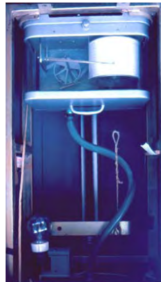
Fig. 6 - A sinistra una capannina meteorologica con strumenti per la misura dei parametri atmosferici ad altezza d'uomo ed un pluviometro a forma di cilindro sormontato dall'imbuto che raccoglie l'acqua delle piogge (vedi anche fig. 2 ). A destra si osservano i meccanismi interni del pluviometro, che consentono la rilevazione continua della misura della pioggia.
