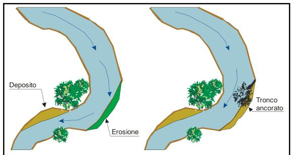
**Fig. 2.18** - Tronco ancorato con funzione di deflettore (Da *Ohio Stream Management Guide*, Ohio Departement of Natural Resources, modif.).
