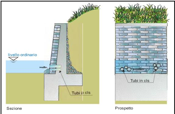
Fig. 22.6 - Ricoveri per pesci, realizzati con tubi in calcestruzzo (cls), nel corpo di muro spondale.
