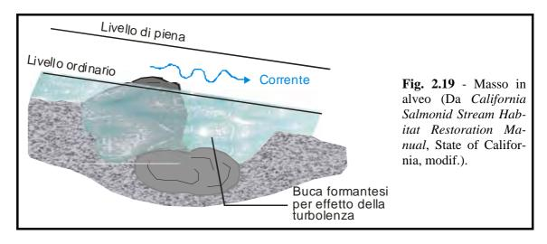
La dimensione degli inerti da impiegarsi dipende, oltre che dalla disponibilità in loco, anche dalle caratteristiche idrauliche del corso d'acqua. Generalmente si utilizzano massi ciclopici del diametro minimo di 0,7 m, incassati sul fondo o vincolati per garantire una maggiore stabilità. In mancanza di materiale di dimensioni adeguate è possibile anche utilizzare piccoli gabbioni, tale sistemazione, tuttavia, comporta un sensibile aumento dei costi di realizzazione.
