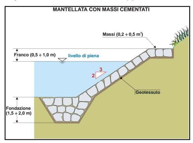
**PARAMETRI E MODALITÀ DI CALCOLO**. Così come per le scogliere, anche per questo tipo di opera è necessario determinare la dimensione media dei massi: esistono diversi sistemi, basati sull'analisi delle forze agenti sull'elemento solido in condizioni di equilibrio limite.
