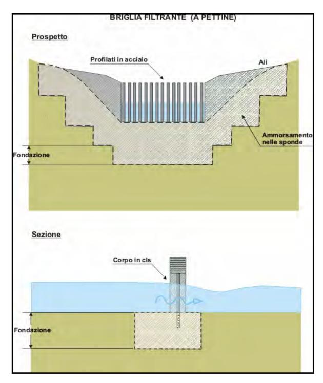
CAMPI DI APPLICAZIONE. Corsi d'acqua caratterizzati da un elevato trasporto solido che necessitino di correzioni della pendenza e riduzione locale o generale della velocità e, quindi, dell'energia cinetica dell'acqua. In genere si utilizzano in corsi d'acqua a regime prevalentemente torrentizio, distinguendo tra situazioni in cui prevale l'attività di trasporto della corrente, in cui si interviene con briglie di consolidamento, e situazioni in cui prevale
