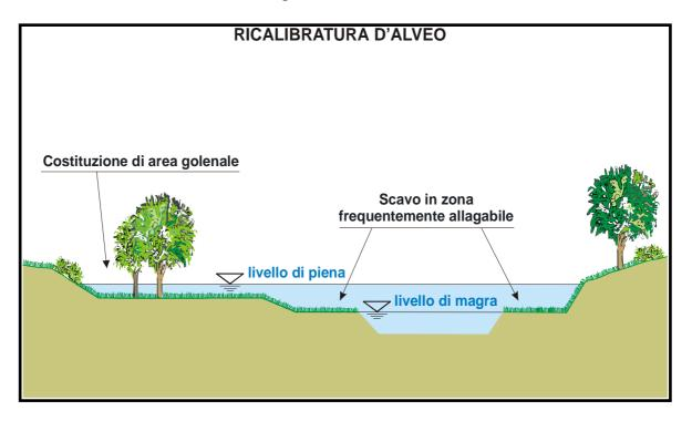
**CAMPI DI APPLICAZIONE.** Tratti fluviali a debole pendenza e quindi a bassa velocità di corrente, dove risulti necessario incrementare la capacità di portata della sezione di deflusso.
