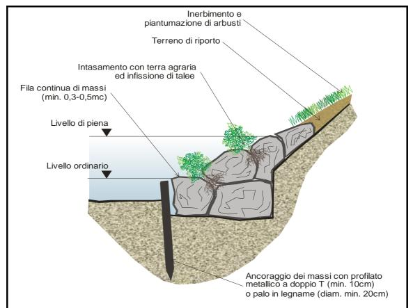
**Fig. 22.7** - Scogliera in massi con talee di tipo armato (Da *Manuale tecnico di Ingegneria Naturalistica della Provincia di Terni*, Provincia di Terni, modif.)
