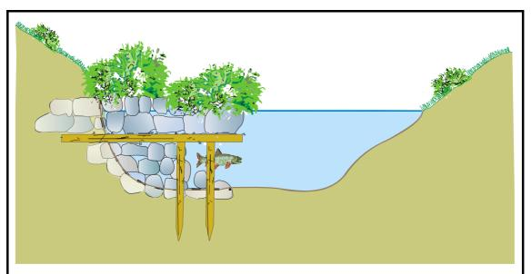
Fig. **2.25** - Ricovero sottosponda nel corpo di deflettore (da *Elementi di progettazione ambientale dei lavori fluviali*, Autorità di Bacino Interregionale del Fiume Maira, modif.).
