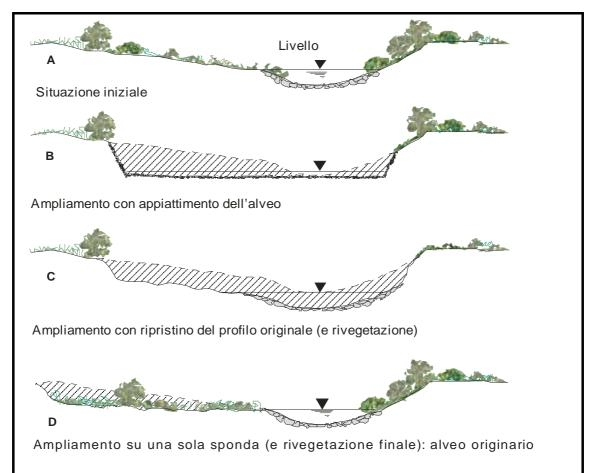
Fig. **22.3** - Modalità di ampliamento dell'alveo ecologicamente scorretto (B) e corretto (C,D). (da *Elementi di progettazione ambientale dei lavori fluviali*, Autorità di Bacino Interregionale del Fiume Maira, modif.).
