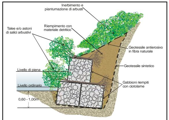
**Fig. 22.4** - Sistemazione spondale a gabbioni - Sezione (Da *Ohio Stream Management Guide*, Ohio Departement of Natural Resources, modif.).
