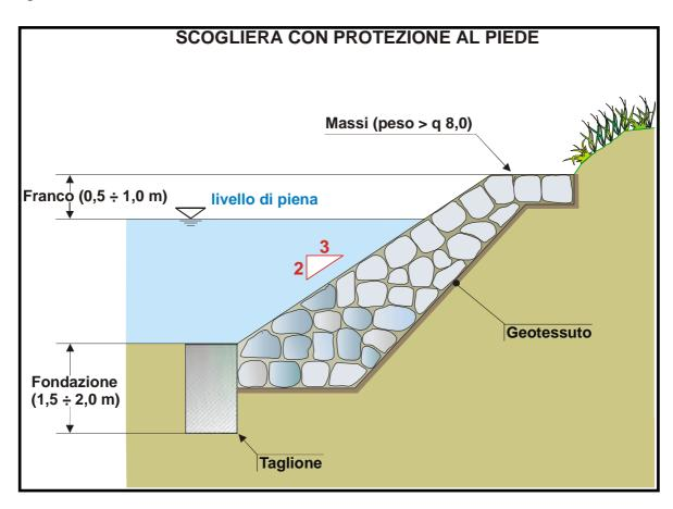
PARAMETRI E MODALITÀ DI CALCOLO. Sono opere staticamente reagenti per il loro peso (opere a gravità), per le quali, in fase di progettazione, è necessario procedere alle verifiche di stabilità tipiche di un'opera in pietrame: scorrimento, ribaltamento, stabilità d'insieme, tensioni interne e sul terreno. Per la determinazione della dimensione media dei massi esistono diversi sistemi, basati sull'analisi delle forze agenti sull'elemento solido in condizioni di equilibrio limite.
